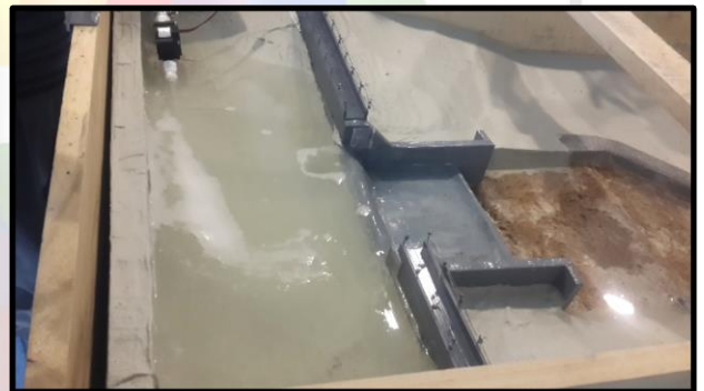
Foto 6 Vertedero de excedencias Presa Pampalarama
