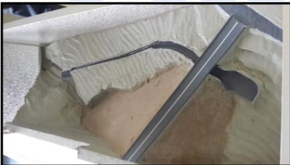
Foto 4 Vertedero de excedencias Presa Chacaltaya
